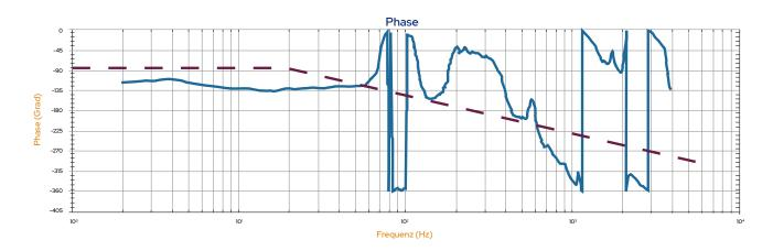
Bei einem perfekten System erwarten wir, dass der Amplitudengraph eine gerade negative Steigung von -20dB/Dekade darstellt. Der Phasengraph sollte bei -90° beginnen und ab dem Punkt, an dem die Amplitude 0 dB kreuzt, mit negativer Steigung abfallen.
