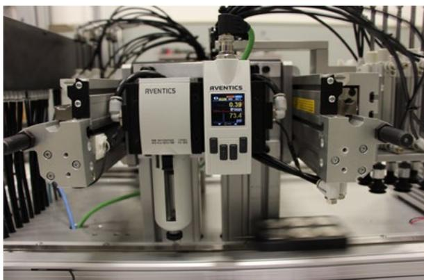
*O AVENTICS Series AF2 é um sensor de fluxo inteligente que monitora o consumo de ar em sistemas pneumáticos, possibilitando a rápida intervenção em casos de vazamento. O que ajuda a otimizar o consumo de energia e evitar a inatividade da máquina.*
