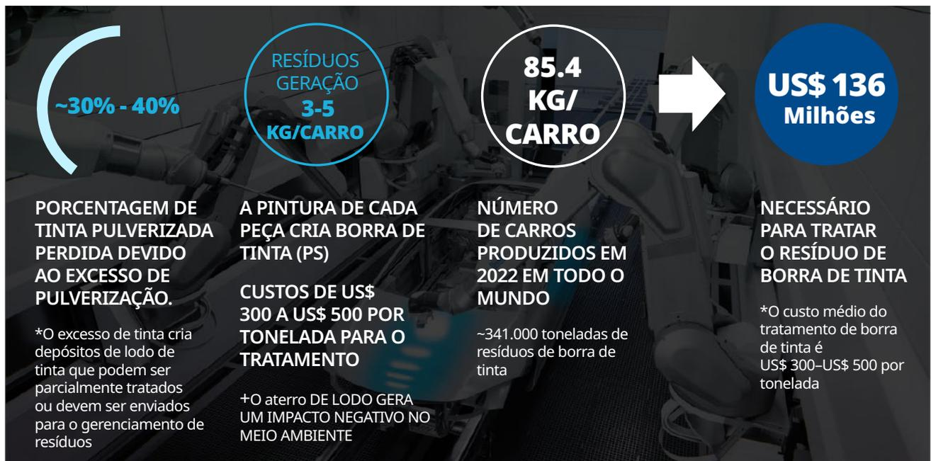
Figura 3: O excesso de pulverização de tinta automotiva contribui significativamente para o desperdício e os custos, com 30 a 40% da tinta perdida, gerando de 3 a 5 kg de borra de tinta por carro.
